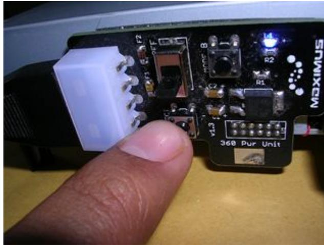
*To eject press and hold the eject button*
